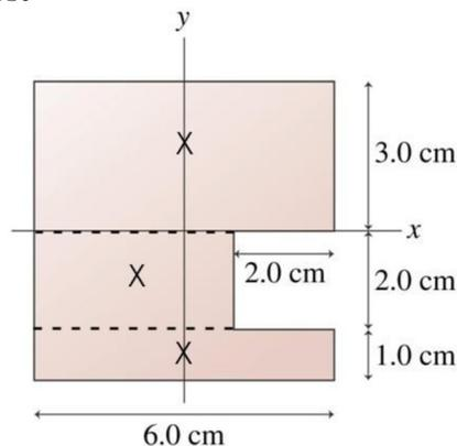
Plaque 1 (celle du haut) :  $m_1 = \sigma \cdot \text{aire} = 100 \frac{\text{kg}}{\text{m}^2} \cdot (0,06\text{m} \cdot 0,03\text{m}) = 0,18\text{kg}$
