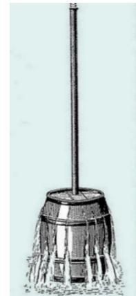
En ajoutant de l'eau, la surface de l'eau s'élève, ce qui fait augmenter la pression dans le baril (puisque la profondeur augmente). Cela n'a aucune importance que le tuyau soit très petit et qu'on doit ajouter seulement une petite quantité d'eau pour le remplir. La seule chose qui compte, c'est la hauteur atteinte par l'eau. Si la surface de l'eau au bout du tuyau est très haute par rapport au baril, la pression dans le baril augmente beaucoup, au point de le faire éclater.
