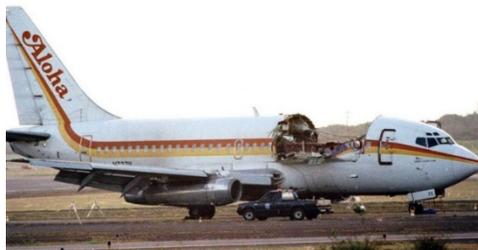
Le 28 avril 1988, une partie importante du fuselage d'un Boeing 737 de Aloha Airlines se détache lors d'un vol entre 2 îles hawaïennes. Une agente de bord a été aspirée vers l'extérieur de l'avion par la sortie rapide de l'air (Mayday, Saison 3, épisode 1).
