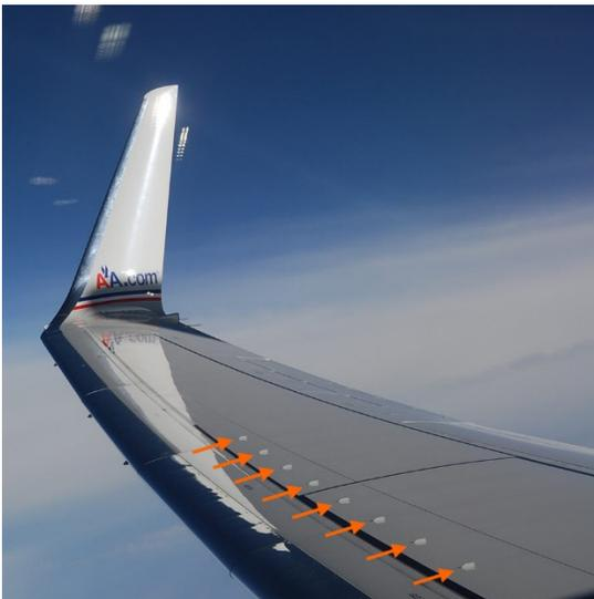
On a vu aussi qu'une couche limite turbulente se sépare moins facilement de la surface. Il y a donc souvent de multiples artifices sur l'aile qui servent à générer de la turbulence dans la couche limite. Ce sont des générateurs de tourbillons (figure de gauche).
