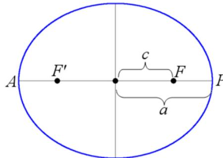
où  $c$  la distance entre le centre de l'ellipse et un des foyers et  $a$  la distance entre le centre de l'ellipse et une des apsides ( $a$  porte le nom de demi-grand axe).
