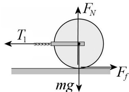
Comme ce cylindre doit aussi rouler, on doit également considérer les moments de force sur le cylindre. Comme il n'y a que la friction qui fait un moment de force, la somme des moments de forces est
