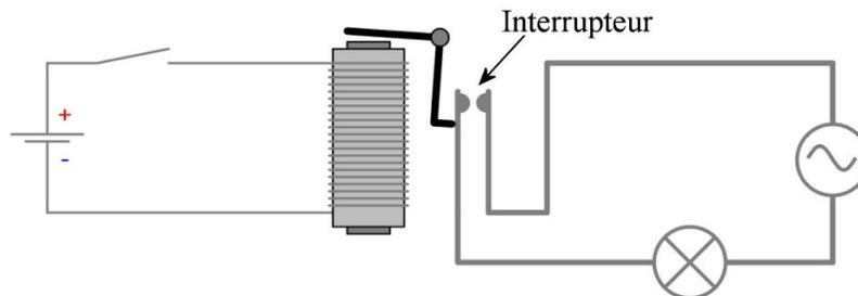
Quand on envoie un courant dans la bobine, elle devient un électroaimant et elle attire la petite plaque métallique au-dessus de la bobine. Cette attraction fait tourner le petit morceau de métal au bout de la bobine, ce qui pousse sur un des côtés de l'interrupteur. Cette poussée fait en sorte que les deux côtés de l'interrupteur entrent en contact. L'interrupteur est alors fermé et le courant peut maintenant circuler dans le 2<sup>e</sup> circuit.
