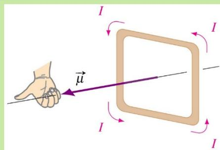
Reprenons notre situation de départ. Dans ce cas, voici la direction du moment dipolaire magnétique. (On a mis en gris le plan de la boucle pour qu'il soit plus évident.)
