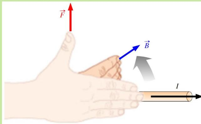
On peut appliquer cette formule pour un bout de fil tant que  $B$ ,  $\theta$  et l'orientation du fil sont constants. Si  $B$  ou  $\theta$  ou l'orientation du fil varient, on sépare le fil en morceaux où  $B$ ,  $\theta$  et l'orientation du fil sont constants, on calcule la force sur chacun de ces morceaux et on somme ensuite pour trouver la force magnétique nette.
