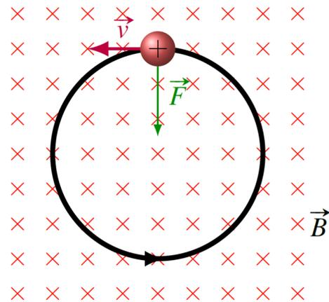
**Rayon de la trajectoire d'une charge dans un champ magnétique uniforme avec une vitesse perpendiculaire au champ magnétique (rayon de Larmor)**
