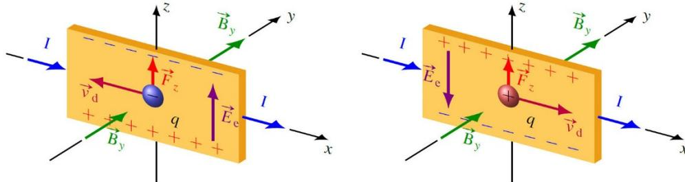
La figure de gauche nous montre que si le courant est fait par des charges négatives se déplaçant vers la gauche, la force magnétique sur les charges est vers le haut, ce qui charge négativement le haut du conducteur et positivement le bas du conducteur.
