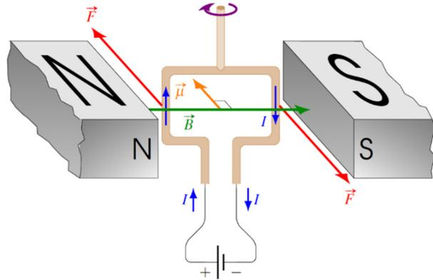
Sauf qu'une fois que  $\mu$  est aligné avec le champ, la boucle cesse sa rotation. C'est alors qu'on va changer le sens du courant dans la boucle. Cela inverse la direction de  $\mu$ , et il n'est plus aligné avec le champ. La boucle doit donc faire un demi-tour pour réaligner  $\mu$  avec  $B$ .
