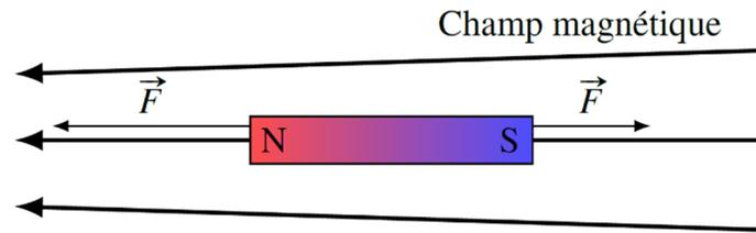
Dans le cas illustré sur la figure, la force sur le pôle nord est maintenant plus grande que celle sur le pôle sud, car le champ est plus grand du côté du pôle nord. Les forces ne s'annulent plus exactement et l'aimant est attiré vers la gauche. On pourrait examiner plusieurs situations pour se rendre compte que, une fois que le dipôle est aligné avec le champ magnétique, il est toujours attiré vers l'endroit où le champ est le plus grand.
