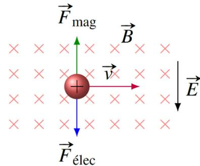
Cette équation indique que la particule doit avoir une vitesse bien précise pour que la force résultante soit nulle. Si on isole la vitesse, on arrive à
