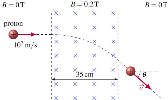
13. Une particule chargée arrive dans un champ magnétique avec la vitesse et l'angle montrés sur la figure pour faire un mouvement hélicoïdal dans le champ magnétique. La masse du proton est de  $1,673 \times 10^{-27}$  kg.
