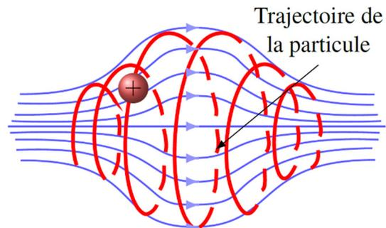
plus faible. C'est ce qu'on appelle une *bouteille magnétique*. Par exemple, on peut utiliser cette bouteille pour contenir des gaz très chaud si on tente de faire de la fusion nucléaire (le gaz est alors à plusieurs millions de °C).
