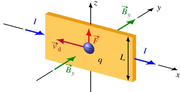
Un courant vers la droite signifie que les électrons se déplacent vers la gauche. Les électrons se déplaçant vers la gauche (vers les  $-x$ ) dans un champ magnétique vers les  $y$  positifs subissent une force vers les  $z$  positifs, donc vers le haut de la plaque. Les charges négatives vont donc aller s'accumuler dans le haut du conducteur alors qu'il y aura un manque de charge négative dans le bas du conducteur. Il se fera donc une séparation de charge.
