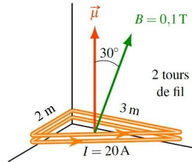
25. Dans la situation montrée sur la figure, la boucle de fil est en équilibre, ce qui signifie que le moment de force fait par le champ magnétique est égal au moment de force fait par le poids de 5 g sur la boucle. Combien y a-t-il de tours de fil dans la boucle ?
