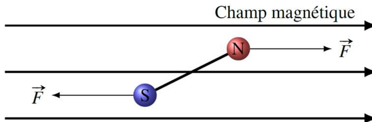
On voit que les forces sur le dipôle l'amènent à s'aligner avec les lignes de champ. Les boussoles, qui sont des dipôles, tournent donc pour s'orienter avec la direction du champ magnétique, exactement comme les dipôles électriques tournaient pour s'aligner avec la direction du champ électrique.
