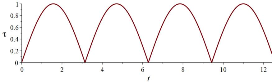
On évite une telle variation de moment de force en utilisant plusieurs bobines de fil légèrement décalées l'une par rapport à l'autre. En envoyant le courant seulement dans la bobine de fil qui est placée à la bonne place pour être au maximum du moment de force, le moteur est presque toujours à son moment de force maximum. Par exemple, imaginons qu'on utilise 3 bobines de fil décalées de  $60^\circ$  l'une par rapport à l'autre.
