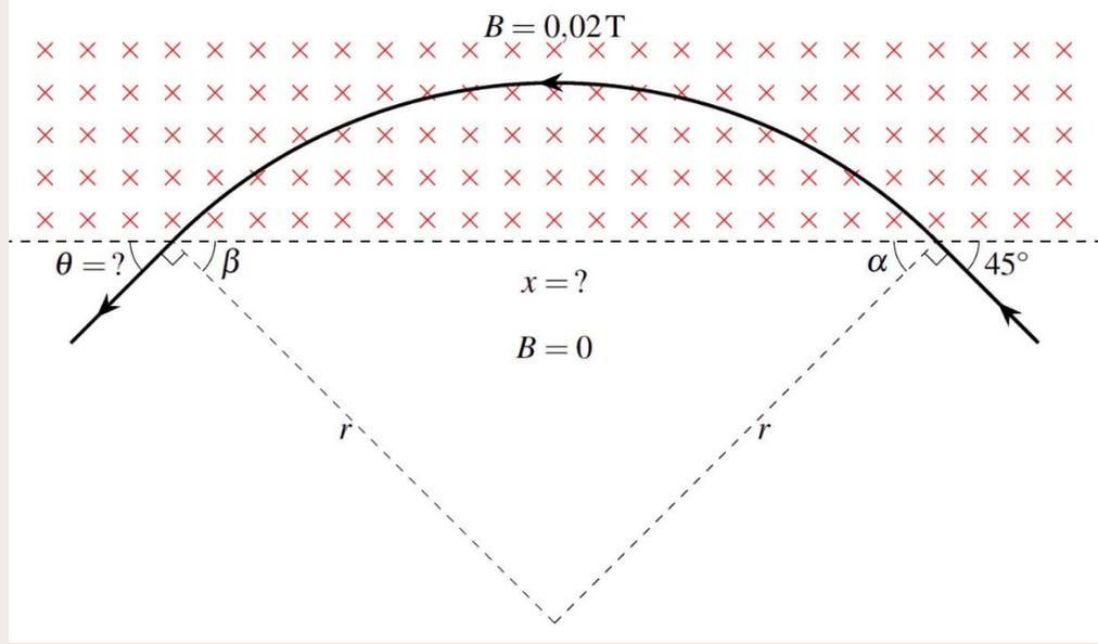
On a alors formé un triangle isocèle puisque deux côtés du triangle ont la même longueur  $r$ . Cela veut dire que les angles  $\alpha$  et  $\beta$  sont égaux. De plus, on peut déduire assez rapidement que  $\alpha = 45^\circ$  (car on doit avoir  $45^\circ + 90^\circ + \alpha = 180^\circ$ ) et donc que  $\beta = 45^\circ$ . Ainsi, on déduit que  $\theta = 45^\circ$  (car on doit avoir  $\theta + 90^\circ + \beta = 180^\circ$ ).
