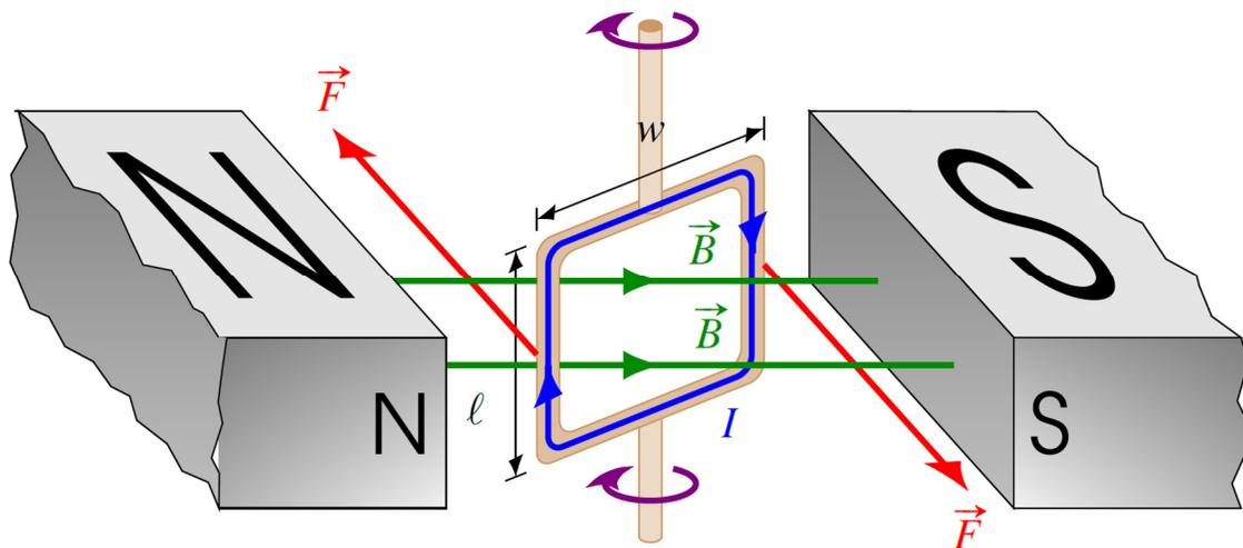
On voit très bien que les deux forces montrées sur la figure, qui donnent une force nette nulle, cherchent à faire tourner la boucle dans la direction indiquée au sommet de l'axe de rotation. (Il y a aussi une force vers le haut sur le dessous de la boucle et une force vers le bas sur le dessus de la boucle, mais ces deux forces ne font pas tourner la boucle.)
