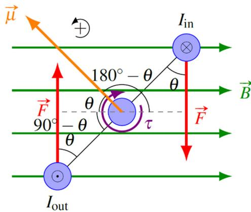
Dans notre formule du moment de force, il y avait l’angle  $\theta$ . Sachez qu’au lieu d’utiliser cet angle entre la force et le plan de la boucle, on peut aussi utiliser l’angle entre le vecteur  $\mu$  et le champ magnétique  $B$ . Cet angle est  $180^\circ - \theta$ , mais cela ne change rien parce que
