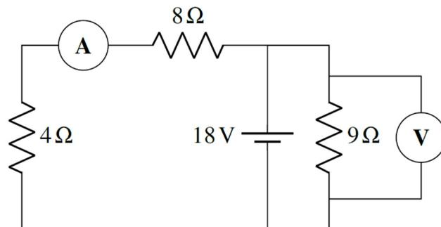
On voit assez facilement que la résistance équivalente est de  $12\ \Omega$  pour la partie gauche du circuit. Cette résistance équivalente est branchée aux bornes de la pile de 18 V. Le courant est donc
