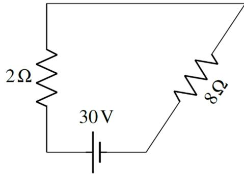
Il ne reste alors qu'une résistance de  $2\ \Omega$  en série avec une résistance de  $8\ \Omega$ . La résistance équivalente est
