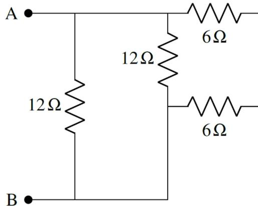
En haut à droite, nous avons alors une résistance de  $6\Omega$  en série avec une résistance de  $6\Omega$ . La résistance équivalente est
