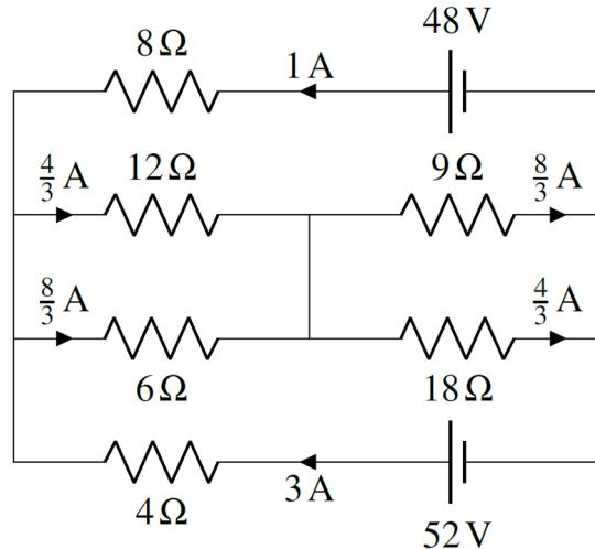
Il ne reste qu'à trouver le courant dans les trois petites branches verticales au milieu du circuit. Pour les trouver, on peut faire des lois des nœuds sur les nœuds en bas de ces branches (nœuds a, b et c sur la figure).
