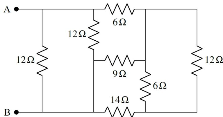
À droite, nous avons alors une résistance de  $12\Omega$  en parallèle avec une résistance de  $6\Omega$ . La résistance équivalente est
