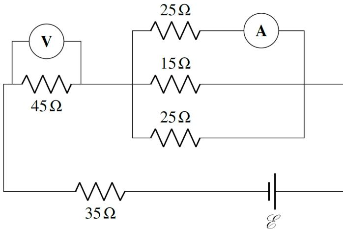
On peut alors trouver la différence de potentiel aux bornes des trois résistances en parallèle puisque la différence de potentiel aux bornes de ces résistances est la même que celle de  $25\ \Omega$  du haut. La différence de potentiel est
