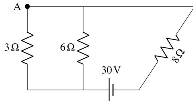
À gauche, nous avons une résistance de  $3\ \Omega$  en parallèle avec une résistance de  $6\ \Omega$ . La résistance équivalente est
