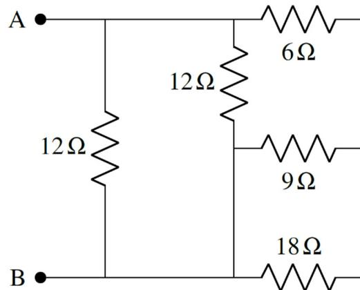
En bas à droite, nous avons alors une résistance de  $18\Omega$  en parallèle avec une résistance de  $9\Omega$ . La résistance équivalente est
