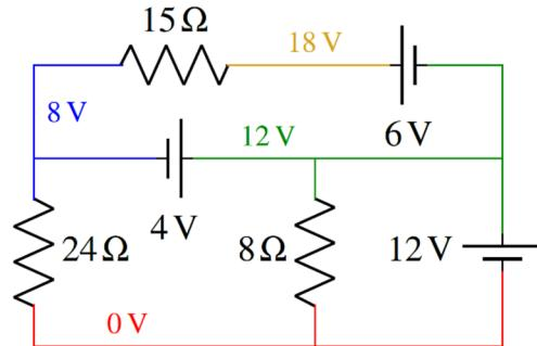
On remarque qu'il y a une différence de potentiel de 12 V aux bornes de la résistance de 8 Ω. Le courant est donc
