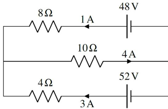
Il reste maintenant à désimplifier le circuit pour trouver les courants dans chaque branche. On ramène premièrement les deux résistances en série. Dans ce cas, le courant dans chaque résistance est le même que celui dans la résistance en parallèle.
