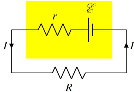
La différence de potentiel aux bornes de la pile est la même que celle aux bornes de la résistance. On peut donc trouver le courant quand on est branché à la résistance de  $20\Omega$ . On a alors
