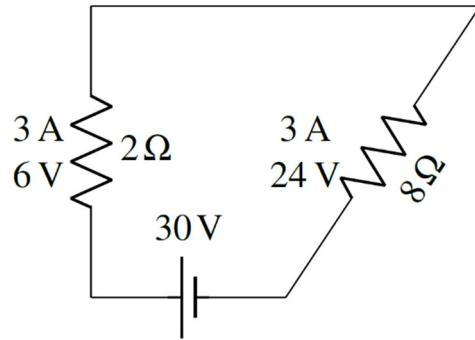
On va alors ramener les résistances en parallèle de gauche. En parallèle, les résistances ont la même différence de potentiel que la résistance équivalente. La différence de potentiel aux bornes de ces résistances est donc aussi de 6 V. Les courants sont donc
