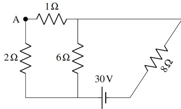
À gauche, nous avons alors une résistance de  $2 \Omega$  en série avec une résistance de  $1 \Omega$ . La résistance équivalente est
