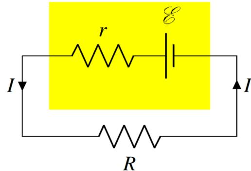
Si la puissance dissipée est de 1250 W et que la résistance est de  $2 \Omega$ , on peut trouver le courant dans la résistance.
