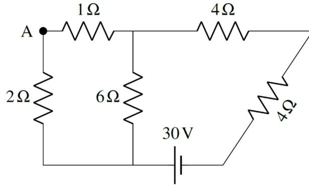
À droite, nous avons alors une résistance de  $4 \Omega$  en série avec une résistance de  $4 \Omega$ . La résistance équivalente est
