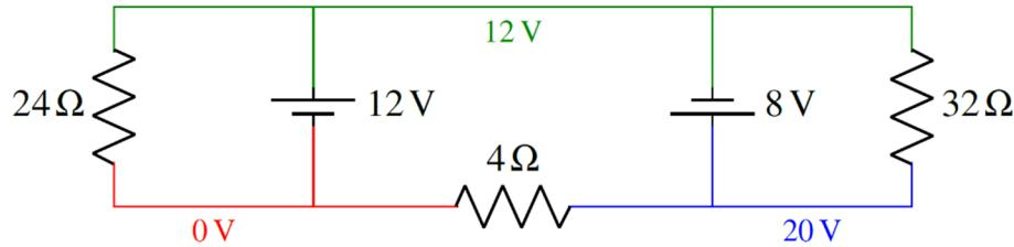
On remarque qu'il y a une différence de potentiel de 12 V aux bornes de la résistance de  $24\ \Omega$ . Le courant est donc
