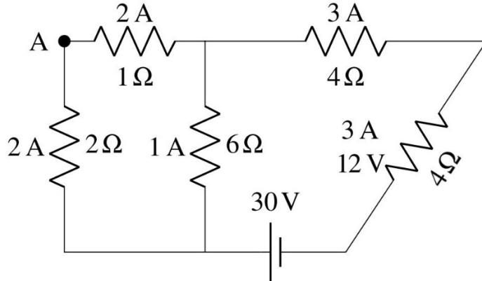
On va alors ramener les résistances en parallèle de droite. En parallèle, les résistances ont la même différence de potentiel que la résistance équivalente. La différence de potentiel aux bornes de ces résistances est donc aussi de 12 V. Les courants sont donc
