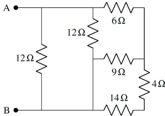
(Remarquez la façon de remplacer des résistances en parallèle par la résistance équivalente : la résistance équivalente prend la place d'une des résistances en parallèle et on efface les branches où il y avait les autres résistances en parallèle.)
