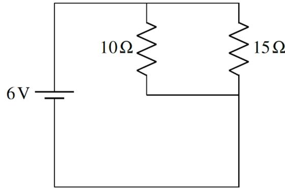
Il ne reste alors que les résistances de  $10\ \Omega$  et  $15\ \Omega$  sont en parallèle. La résistance équivalente est
