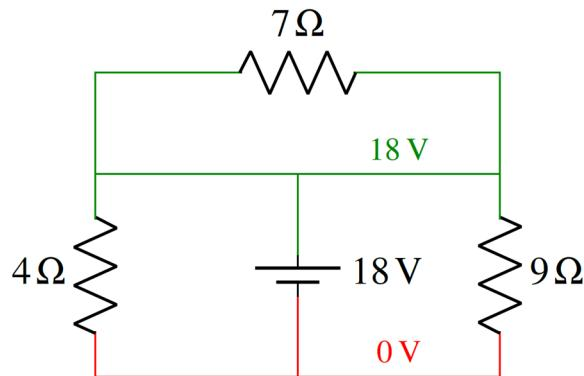
On remarque alors que les deux côtés de la résistance de  $7\ \Omega$  sont au même potentiel. Il n'y a donc pas de différence de potentiel aux bornes de cette résistance, et il n'y a donc pas de courant dans cette résistance.
