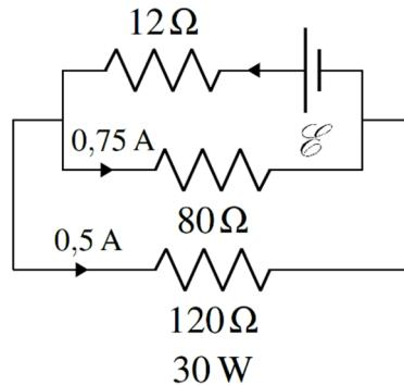
En appliquant la loi des nœuds (nœud de gauche), on trouve le courant dans la résistance de  $12\Omega$ .
