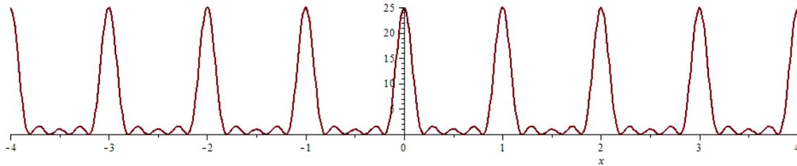
Avec une source non ponctuelle comme une étoile, on aura la superposition de plusieurs de ces figures d'interférences. En étudiant bien l'intensité de cette superposition, on peut déduire la taille de la source sans même changer la distance entre les antennes.
