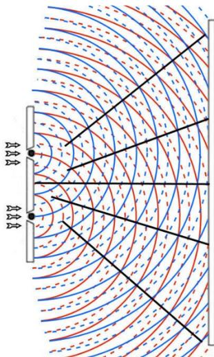
Il y a des endroits sur l'écran (qui est à droite sur la figure) où les ondes font de l'interférence constructive. À ces endroits, les maximums des deux ondes se superposent pour donner une onde de grande amplitude. C'est ce qui se produit le long des lignes droites pleines. C'est le long de ces droites que les cercles pleins représentant les maximums des ondes se croisent.
